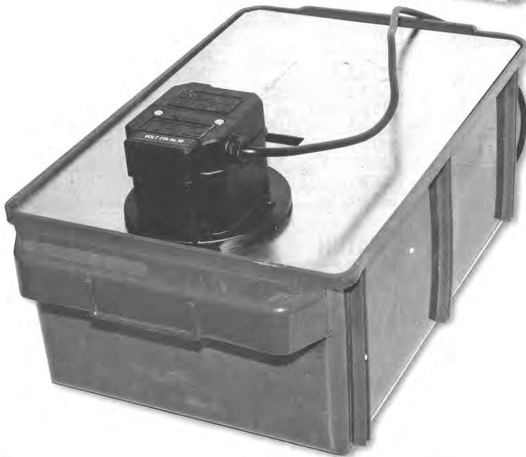
Nr. 16 Kronoglas- Maschine mit Getriebemotor zum Schleifen von Mineralgläsern
